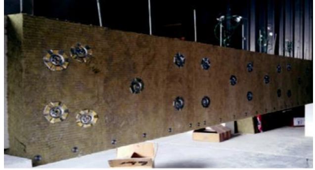
Belka betonowa z izolacją ogniochronną
