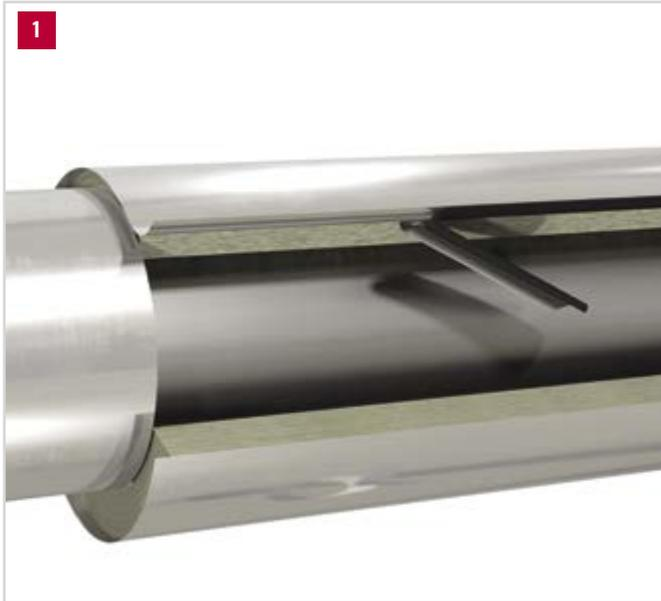
1. Montieren Sie die Rohrschale spannungsfrei auf die Rohrleitung. Dabei möglichst keine Spalte bzw. Hohlräume verursachen, auf dichte Montage achten, so dass eine optimale Dämmleistung erreicht wird. Unvermeidbare Hohlräume können mit PAROC® Pro Loose Wool (Stopfwolle) verschlossen werden.
