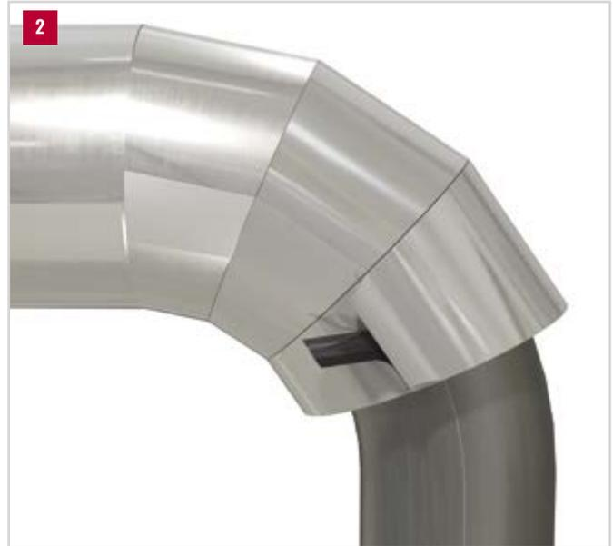
2. Bei Rohrbögen sind PAROC® Pro Bend WR 140 Clad oder PAROC® Pro Segment WR 140 Clad zu empfehlen, diese werden spannungsfrei und ohne Hohlräume montiert. Als Alternative dienen Schablonen, ähnlich wie bei Bogensegmenten aus Metall.
