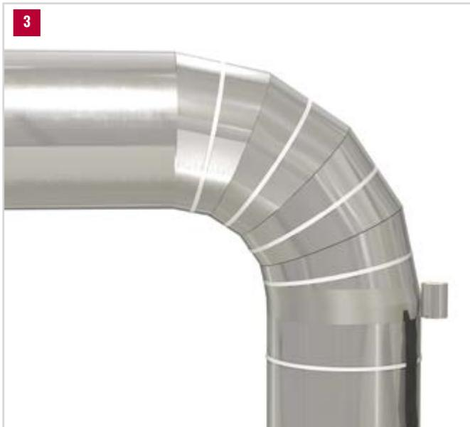
3. **Schließen Sie alle Stoßverbindungen mit Klebeband und gehen Sie dabei wie folgt vor:** Alle Längs- und Stoßverbindungen müssen mit PAROC® Clad Alu Tape verschlossen werden. Für gerade Passstücke darf nur Klebeband mit einer Breite von mindestens 75 mm verwendet werden; (ggf. eine Breite von 100 mm). Schmalere Bänder dienen zur Abdichtung bei engen Platzverhältnissen, Bogensegmenten oder Abzweigungen.
