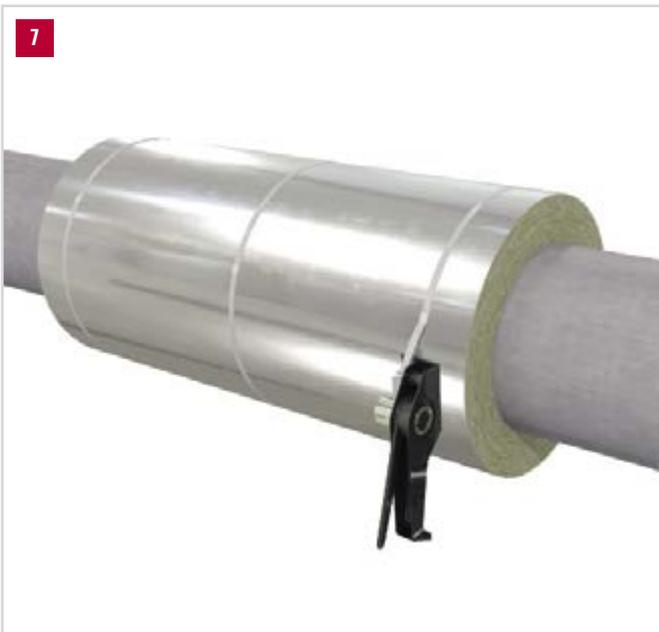
**7.** Zur dauerhaften und zusätzlichen Fixierung der Rohrschalen verwenden Sie bitte Aluminiumbänder oder witterungsbeständige Kunststoffbänder (mind. 19 mm Breite). Der Abstand sollte 300 mm nicht überschreiten. Für ein optimales Finish und stabilere Fixierung können diese mit PAROC® Clad Alu Tape abgedeckt werden.
