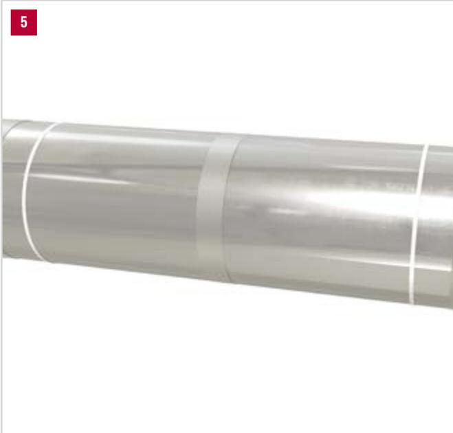
**5. Position des Klebebandes:** Vermeiden Sie abzudichtende Längsnähte im oberen Bereich von Rohren. Diese eher in 3 Uhr oder 9 Uhr Stellung positionieren (Ziffernblattdarstellung). Durch diese Platzierung der Verbindungen sind sie weniger exponiert und tragen zu einer zuverlässigen sowie nachhaltigen Abdichtung bei.
