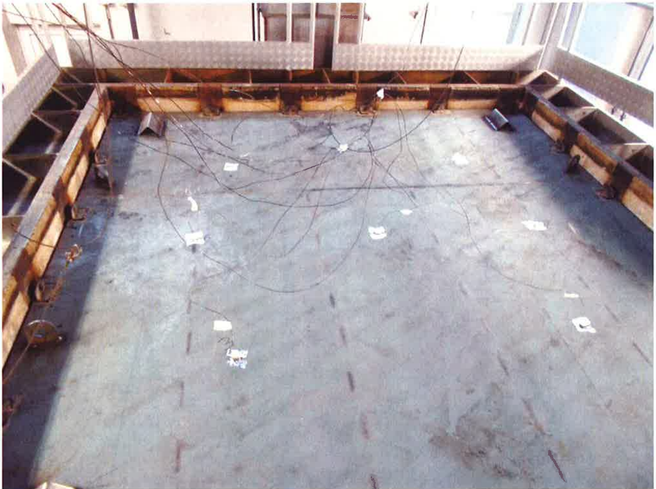
Fig. 2 La faccia non esposta del campione prima della prova Fig. 2 Unexposed face of test specimen before test
