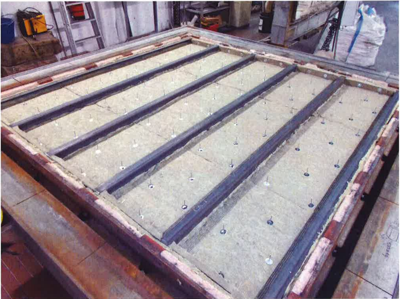
Fig.1 La faccia esposta del campione prima della prova Fig. 1 Exposed face of test specimen before test
