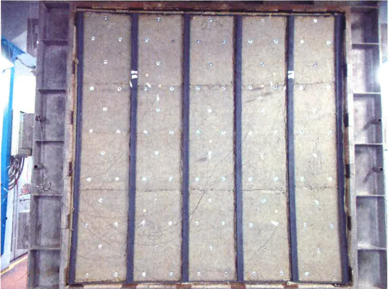
Fig. 4 La faccia non esposta del campione dopo la prova Fig. 4 Unexposed face of test specimen upon completion of test
