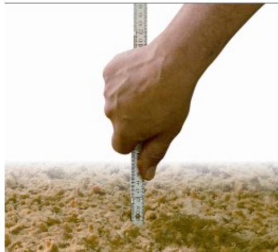
PAROC-kivivillasta valmistettu puhallusvilla ei pala, ei painu, ei ime vettä eikä varastoi kosteutta.
